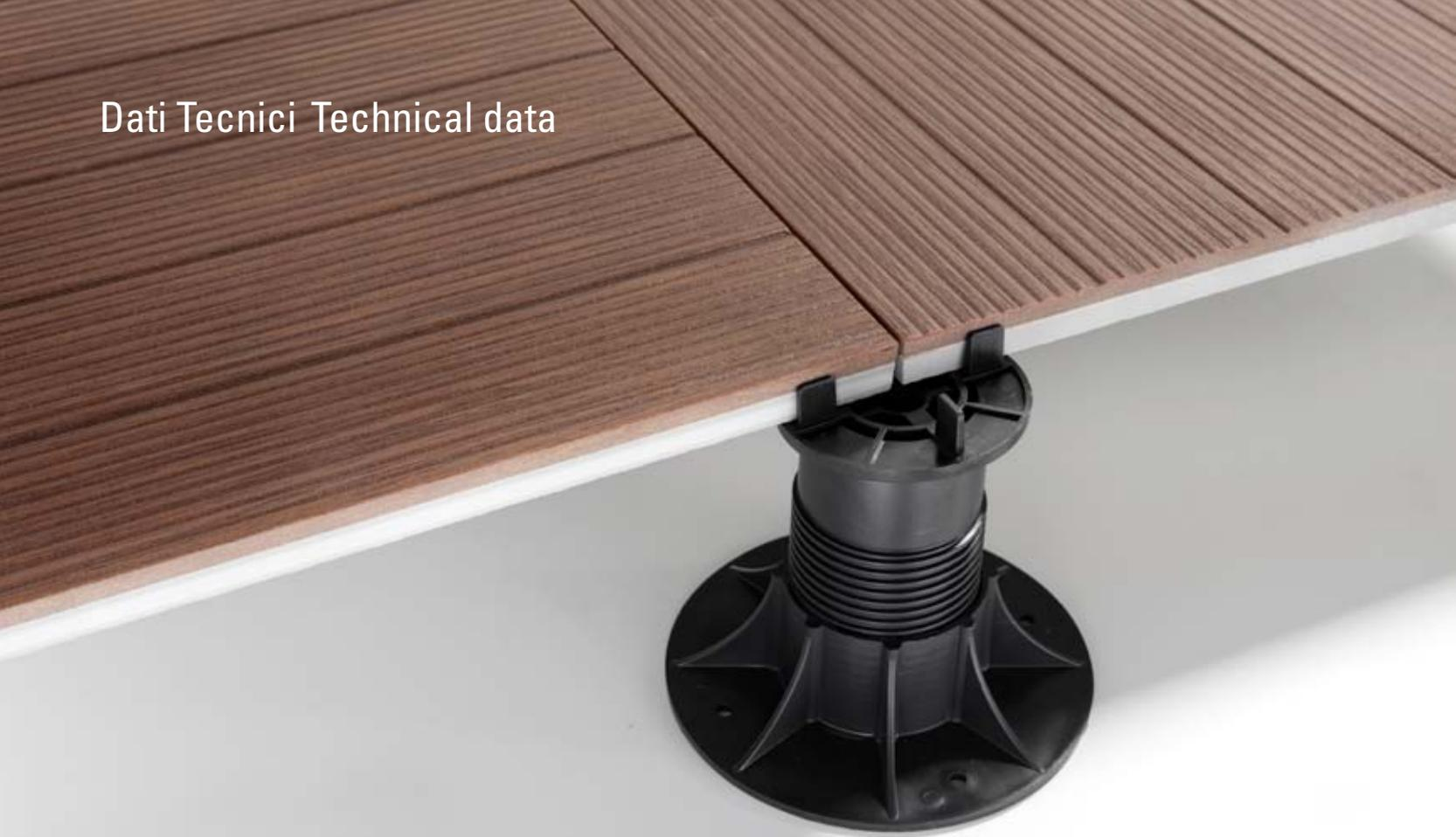
La pavimentazione sopraelevata da esterni è caratterizzata da un modulo di dimensione 600x600mm, ottenuto con un pannello di dimensioni nominali 596x596mm ed una fuga tra pannelli adiacenti di larghezza nominale 4mm. Il pannello è ottenuto per incollaggio della copertura sull'anima. Non è applicato alcun rivestimento inferiore né bordo plastico perimetrale.
